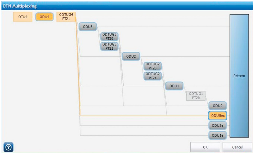
图52. Pattern-ODUflex-ODU4的映射路径。
