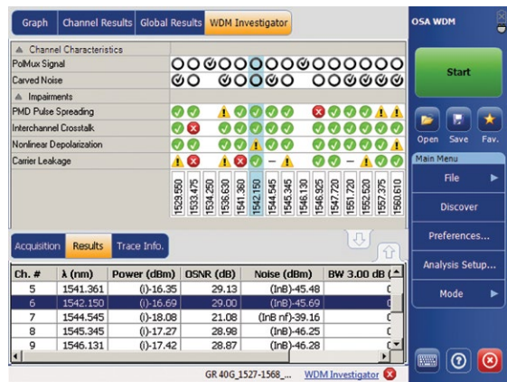
图 111. WDM检测器读数显示非线性解偏振导致更多噪声（OSNR e ）。
