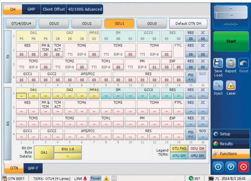
图53. EXFO公司OTN分析仪的ODUflex开销字节分析界面。
