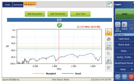
Abbildung 35. Eine Messung des Längenausgleichs in einer TAL
